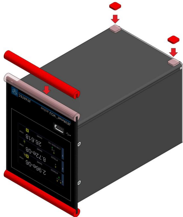
Abbildung 5 – Vorbereitung der Geräteunterseite zur Verwendung als Tischgerät
