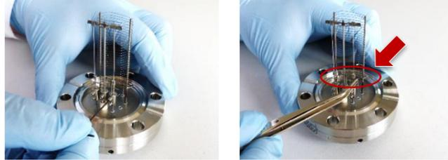
**WARNUNG:** Das Nichtentfernen der Transportsicherung zwischen den Filamenten kann zu einem Kurzschluss und zur Zerstörung der Messelektronik führen.
