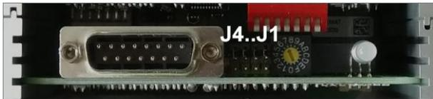
Abbildung 15 – Jumper für Einstellung der Betriebsparameter bei entfernter Deckelplatte
